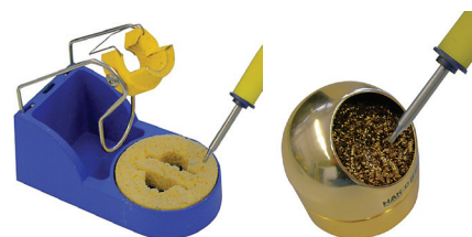
Obr. 2 Čištění hrotu pomocí houbičky a drátků
