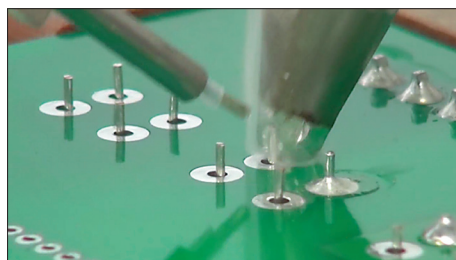
Obr. 2 Kontaktní pájení HAKKO robotickým systémem
