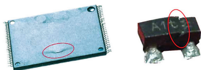
Obr. 1 Viditelné poškození součástek MSD během pájení přetavením
