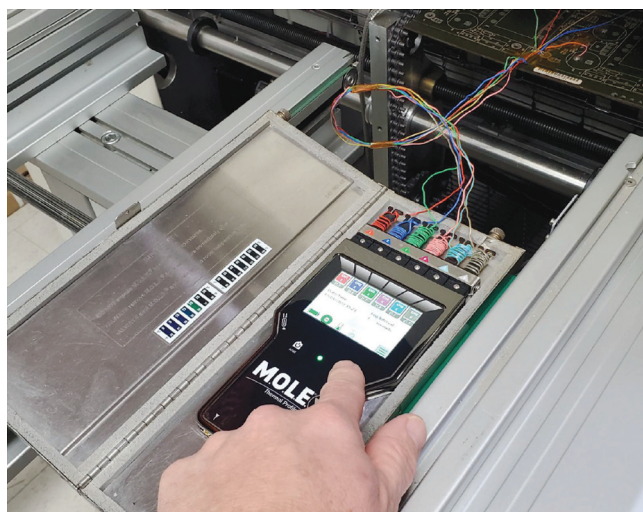
Obr. 1 Měření s teplotním profiloměrem v provozu
