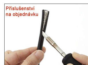
Obr. 4 Pro kabely většího průměru lze použít speciální čepel
